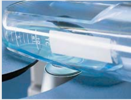
Inversives Mikroskopieren eines Zellkulturflachröhrchens
