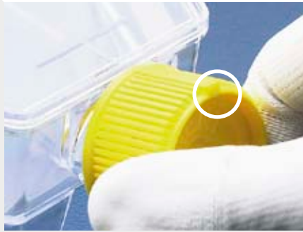
VENT-Position 12 Uhr = Gasaustausch
